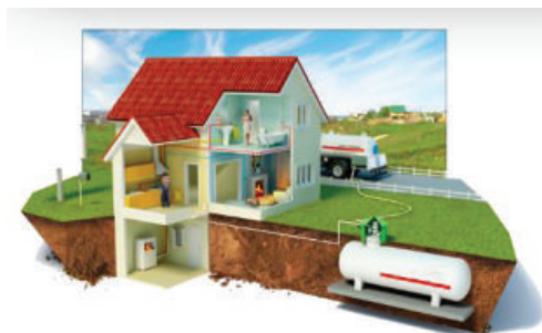
Рисунок 1 – Заправка подземного резервуара СУГ
